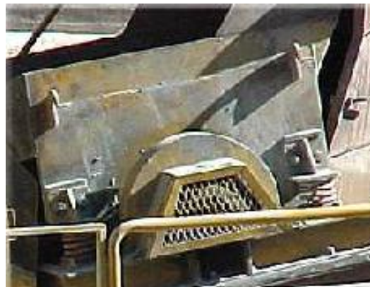
Ilustración 10. Zaranda de Vibración Fuente: Grupo Minero Loor
