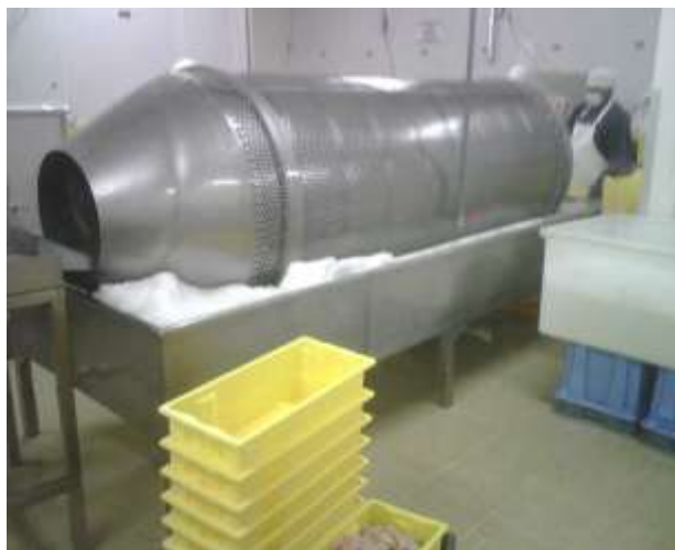
Imagen No. 31: Chiller para tilapia propiedad de Modercorp S.A. – Guayaquil, Ecuador.
