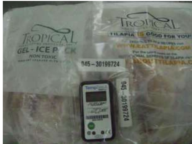
Imagen No. 3: Gel pack y termógrafo colocados dentro de una hielera perteneciente a la marca Tropical Aquaculture Products.
