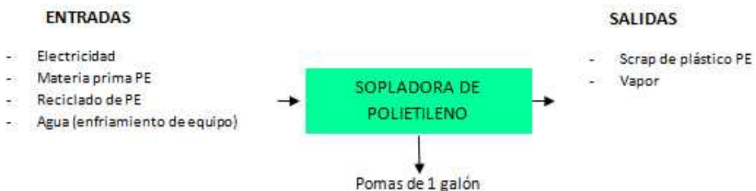
Figura 2. (Proceso productivo para la elaboración pomas PE)
