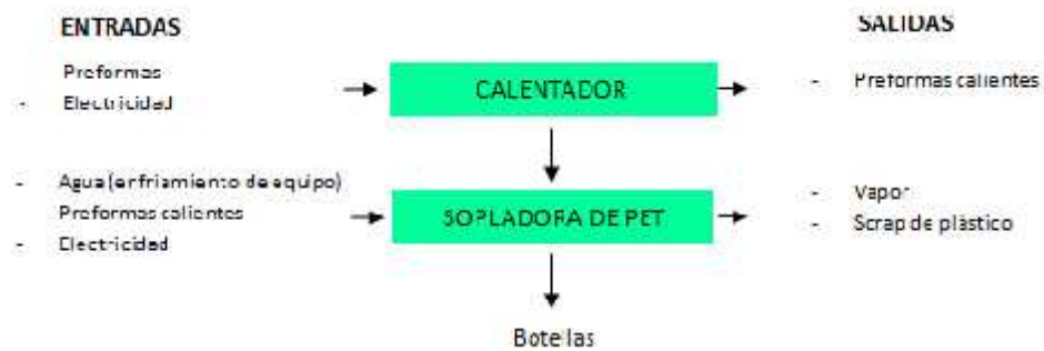
Figura 4. (Proceso productivo para la elaboración de botellas, botellones y vasos copa PET)
