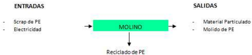
Figura 7. (Proceso productivo para el reciclado de PE)
