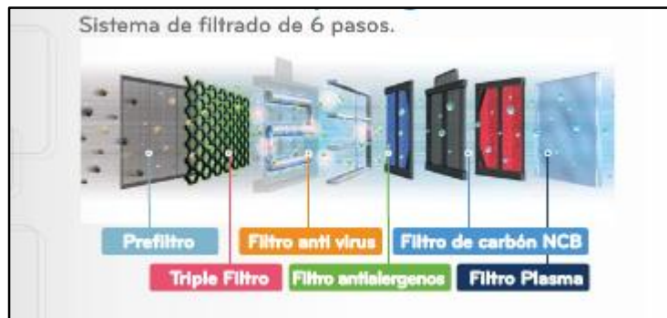
Imagen 22. Sistema de filtrado de 6 pasos de los aires acondicionados LG
