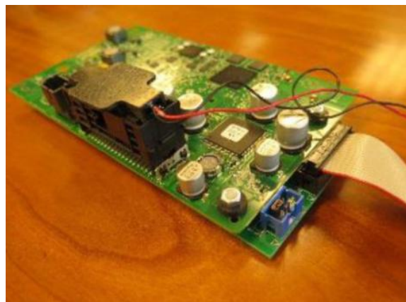
Imagen 3: Placa de circuito extraída de un sistema infotainment, para inicio de adquisición física intrusiva
