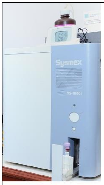
Gráfico 20. Máquina XS 1000 para la determinación del conteo linfocitario del laboratorio clínico del hospital de arenillas. Foto original de Robert Ordóñez G
