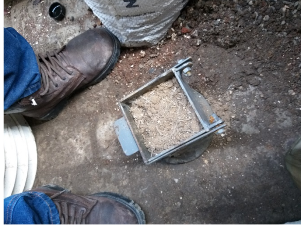
Figura 3. 18 Segunda capa para compactación de bloque de 10x10 cm
