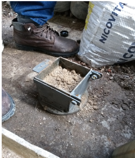
Figura 3. 17 Primera capa para compactación de bloque 10x10 cm
