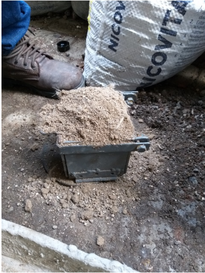
Figura 3. 19 Tercera capa para compactación de bloque de 10x10 cm
