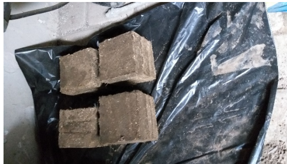
Figura 3. 21 Bloques 10x10 cm de adobe con cal y fibra de vidrio.
