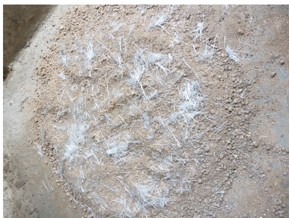
Figura 3. 14 Mezcla en seco con fibra de vidrio
