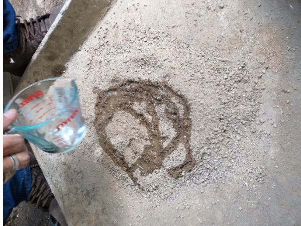
Figura 3. 16 Adherencia de agua a la mezcla
