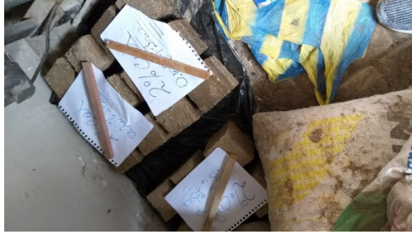
Figura 3. 22 Bloques de adobe con cal y fibra de vidrio (0.10%, 0,15% y 0,20%)
