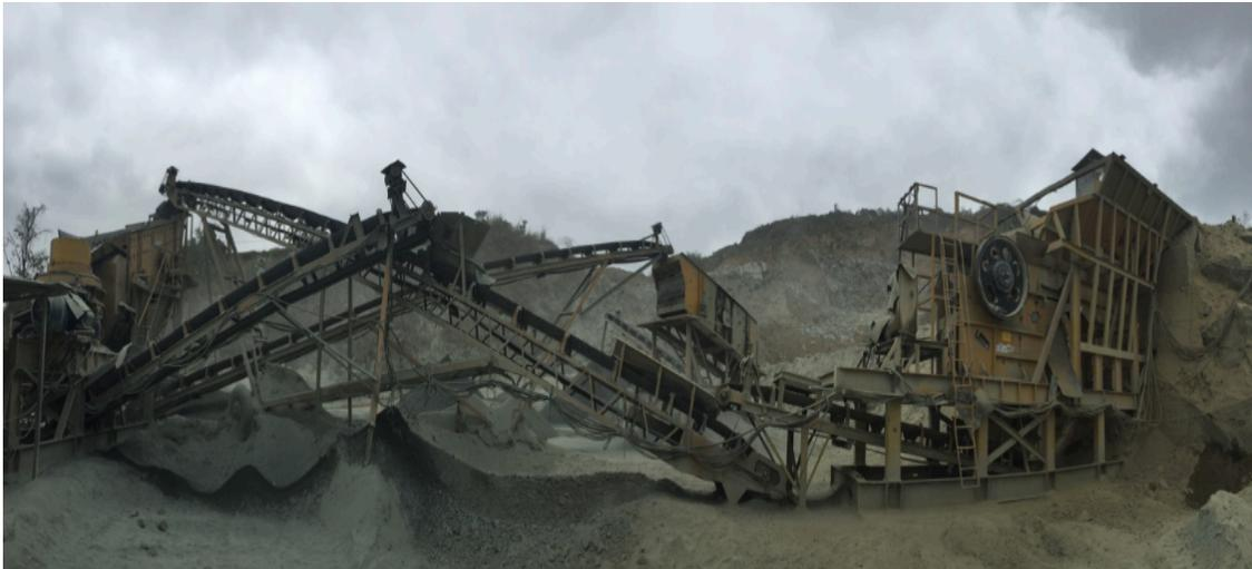
**Figura 8.** Alimentación a la mandíbula y transporte de material por bandas
