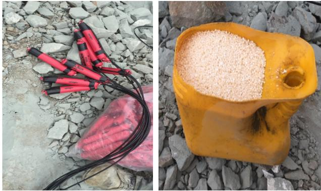
**Figura 2.10** Carga de explosivos: a) Emulsión explosiva encartuchada con mecha de seguridad e iniciador, b) Nitrato de amonio
