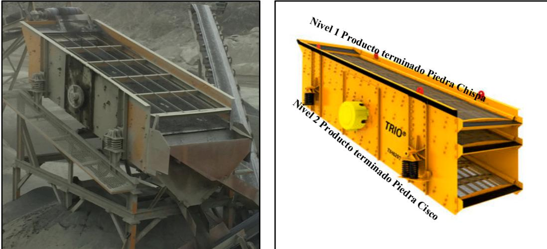
**Figura 3.5** Zaranda vibratoria #2 con 2 niveles de clasificadoras
