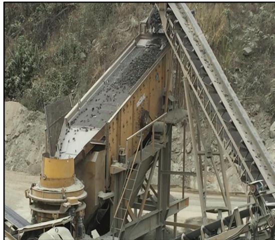
**Figura 3.2** Zaranda vibratoria #1 con 3 niveles de clasificadoras
