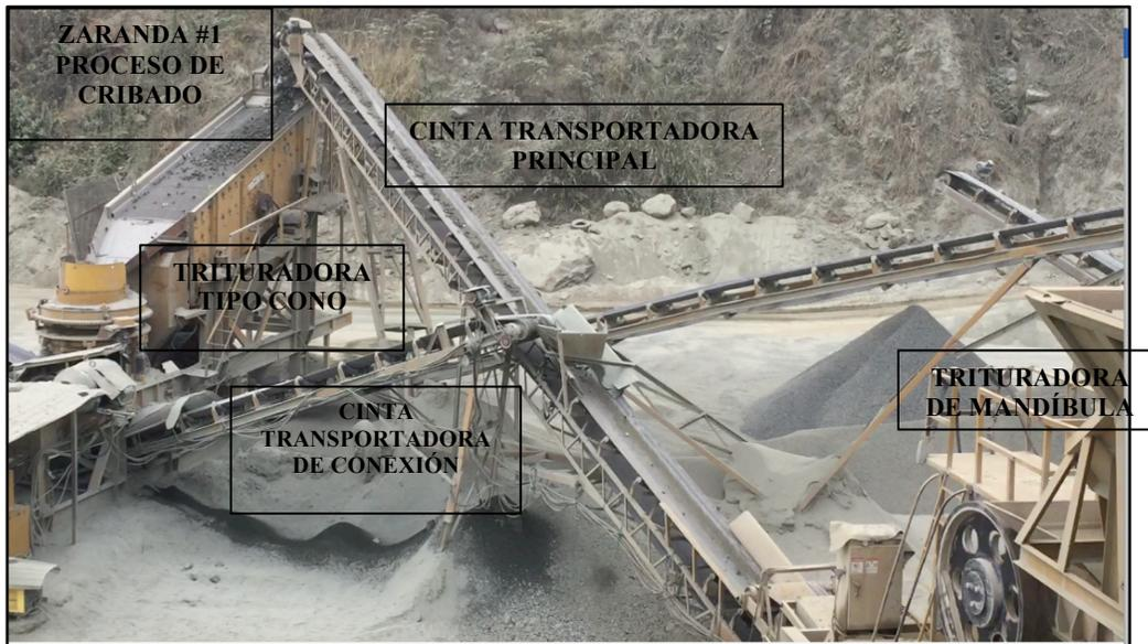
**Figura 3.6** Flujo del proceso de trituración y cribado del agregado
