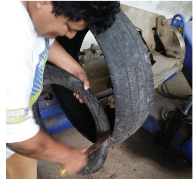
Imagen # 53 Corte de la Banda de Rodamiento
