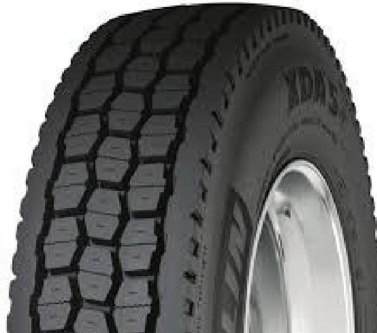
Imagen # 15 Banda de Rodamiento tipo Bloque
