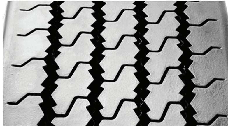
Imagen # 14 Banda de rodamiento tipo Costilla
