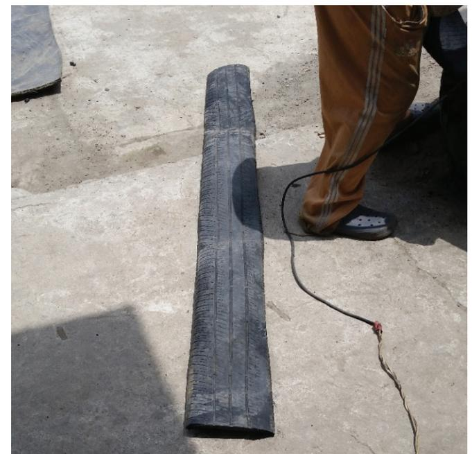
Imagen # 55 Extracción de la Banda de Rodamiento
