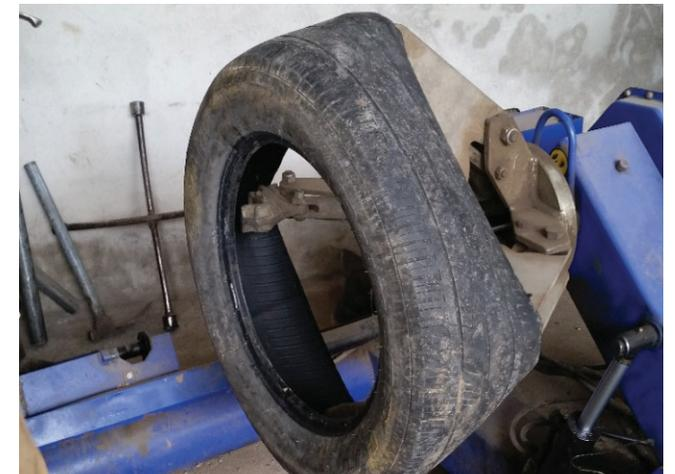
Imagen # 52 Corte de la Banda de Rodamiento
