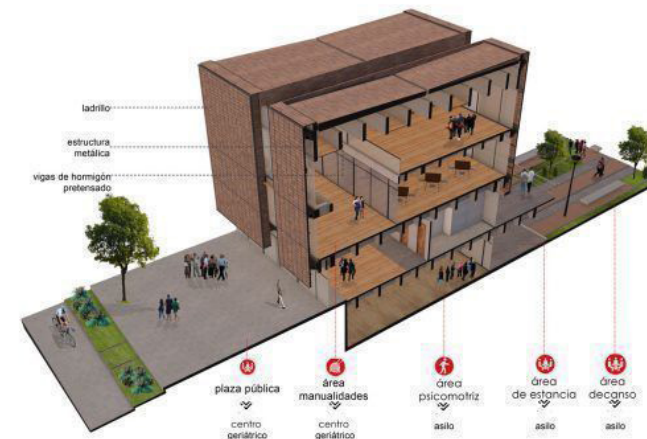
Imágen 29. Corte arquitectónico de propuesta para Hogar Cristo Rey, Cuenca, Ecuador.
