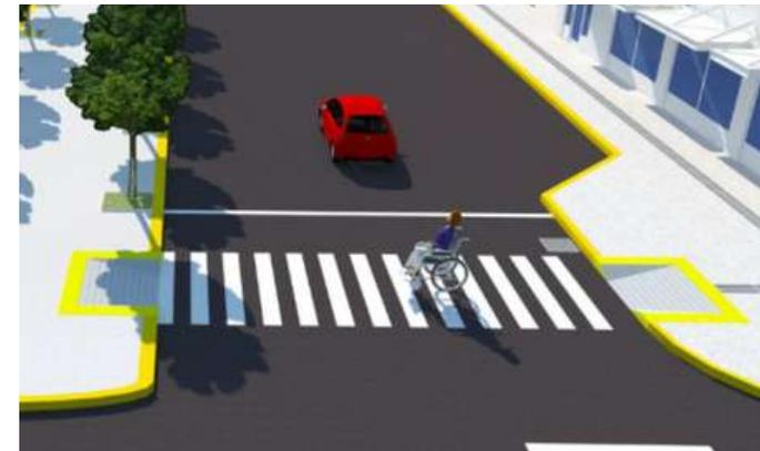
Imagen 23. Vista de vía con desnivel existente entre el parterre y la calzada
