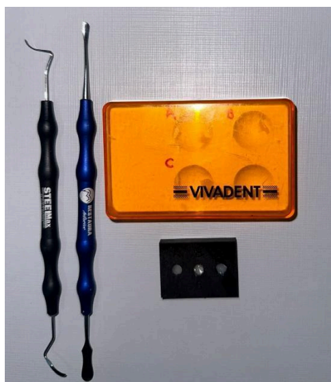
Imagen 1. Elementos entregados a cada participante: 2 espátulas, matriz con 3 cavidades, caja con protección halógena con las dosificaciones de las tres resinas compuestas en su interior previamente etiquetadas con su respectiva letra.
