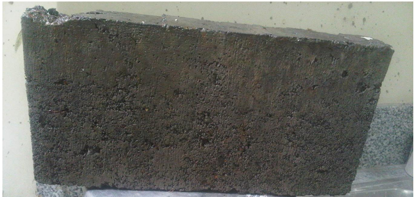
Realizado esto, procedimos a pesar los bloques en estado saturado con la superficie seca. ( $W_{ss}$ ).
