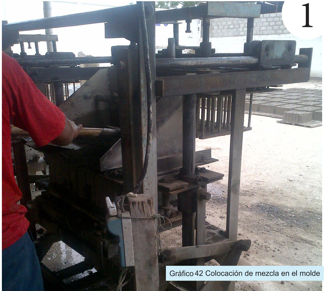
Gráfico 42 Colocación de mezcla en el molde
