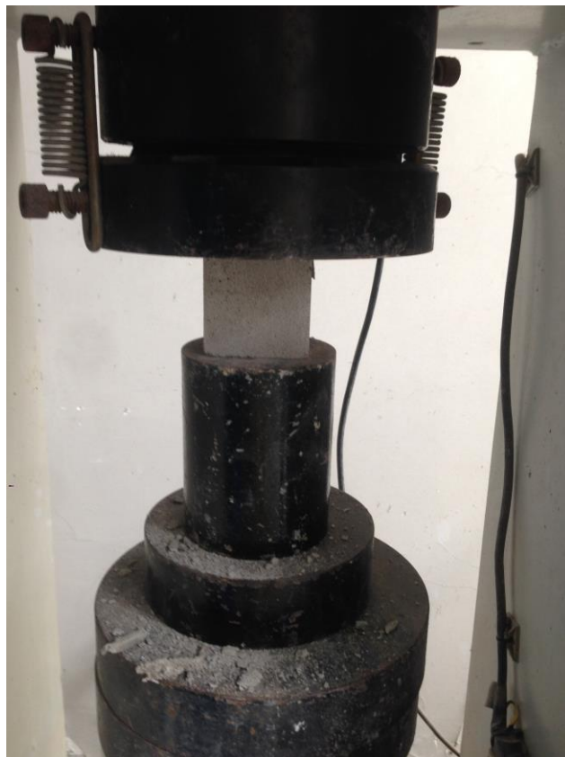
Ilustración 5: Ensayo a compresión
