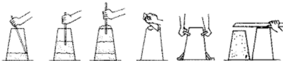
Fig. 4.11 Ensayo de asentamientos del cono de Abrams.
