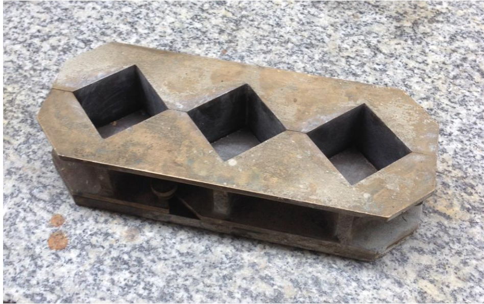
Ilustración 4: Molde cubos mortero
