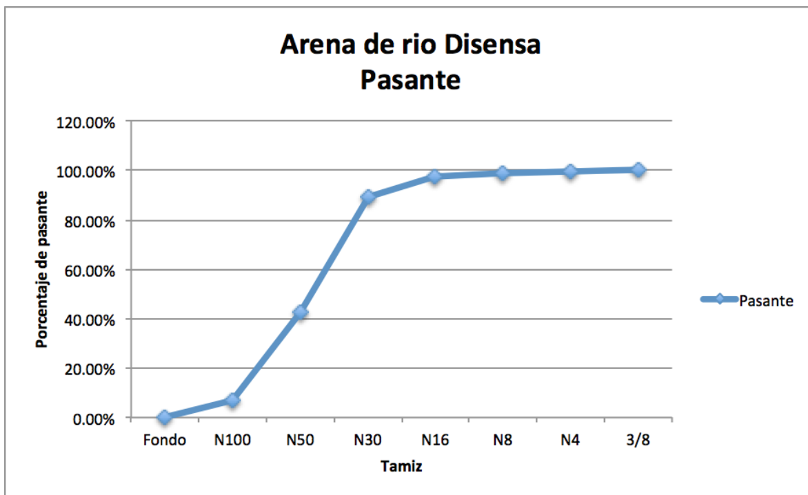
Ilustración 13: Ensayo granulométrico arena de río Disensa
