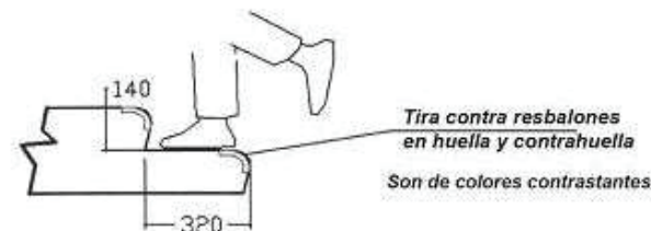
Figura 79: Propuesta de mejoramiento de escalones C.C. Riocentro Entreríos Fuente: (Cámara de la Industria de la Construcción, 2011)
