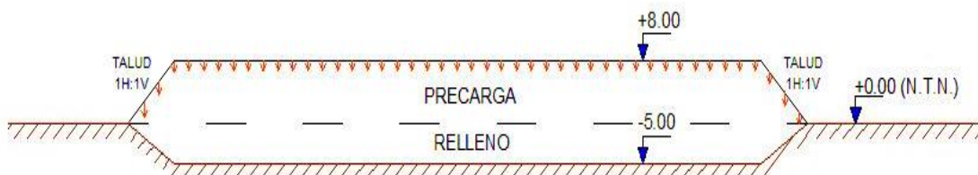
Figura 6: Esquema de relleno con precarga
