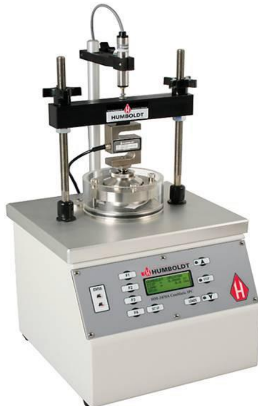
Figura 22: Consolidómetro marca Humboldt
