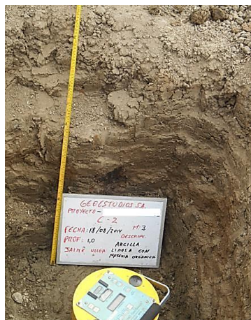
Figura 10: Calicata con profundidad de un metro
