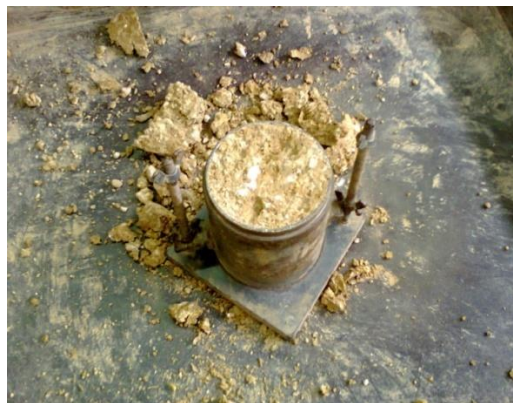
Fotografía 3 Compactación de la muestra
