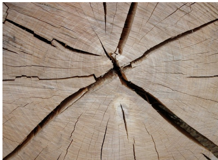
Ilustración 30: Contracción de fibras en la madera.
