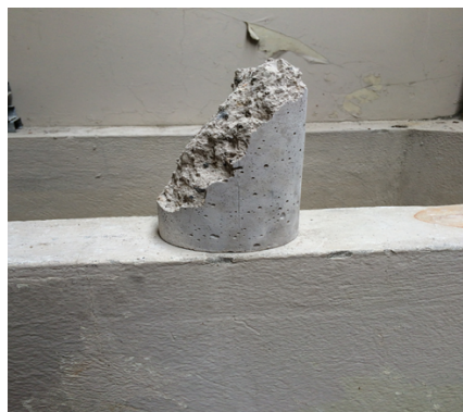
Figura 34. Cilindro después de la rotura
