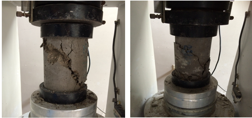
Figura 33. Rotura a compresión
