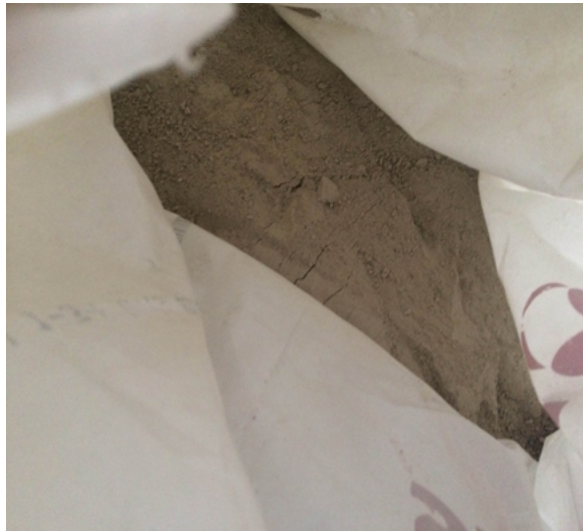
Figura 2. Agregado fino de Piedra Pómez.
