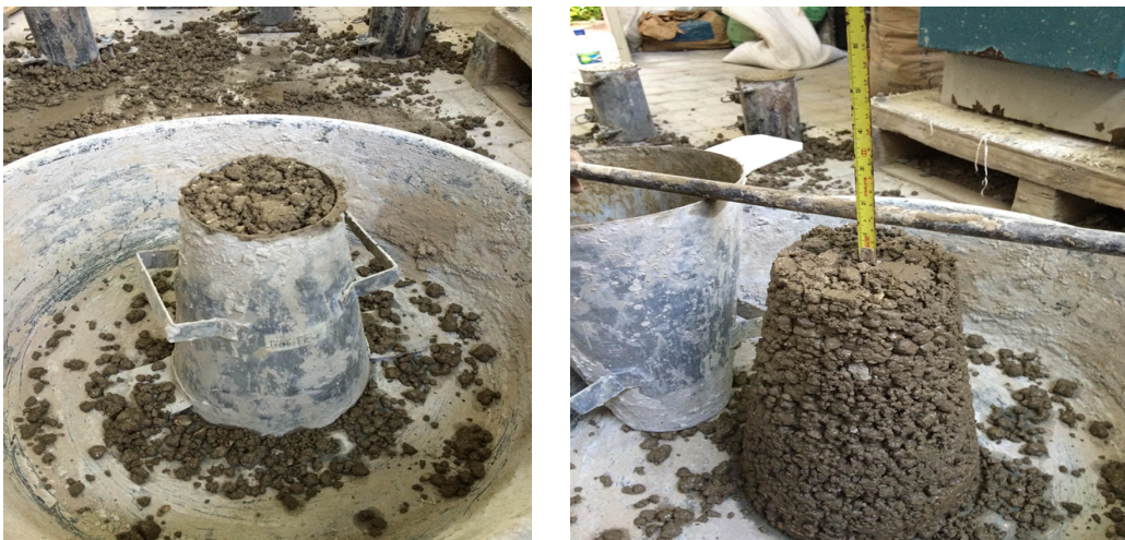
Figura 6. Ensayo del cono de Abrams.
