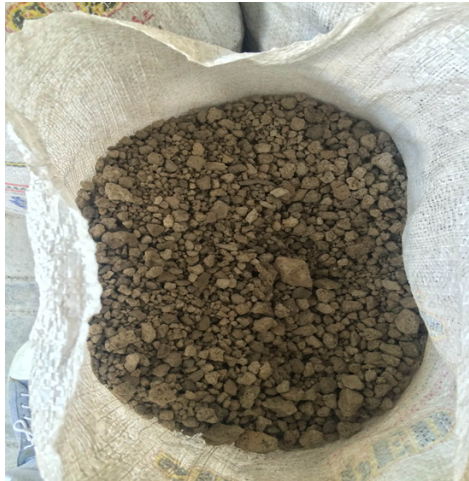
Figura 3. Agregado grueso de Piedra Pómez.
