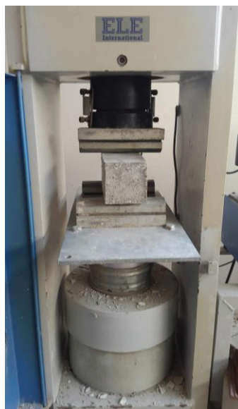
Figura 39. Vigueta durante la prueba de flexión
