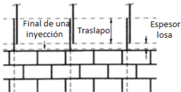
Figura 24. Traslazo de los refuerzos para continuación de pared sobre losa
