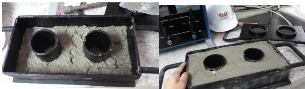
Figura 46. Colocación y compactación de muestra en el molde del bloque
