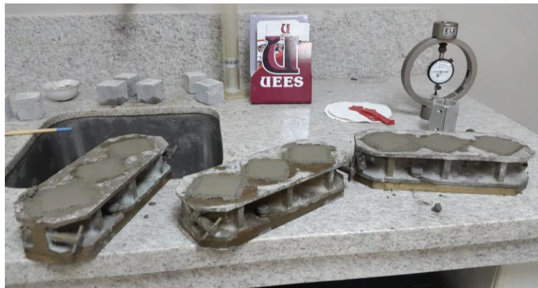
Figura 34. Material en moldes cúbicos de 5 cm
