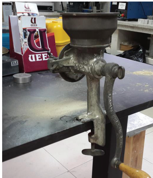
Figura 31. Proceso de trituración de la cascarilla de arroz
