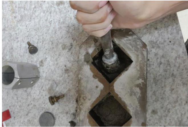
Figura 33. Colocación de muestra en moldes y compactación
