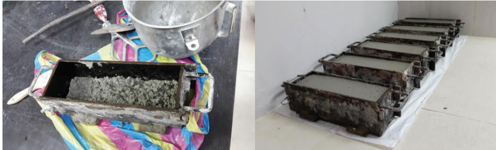
Figura 38. Colocación de muestra en molde de viguetas
