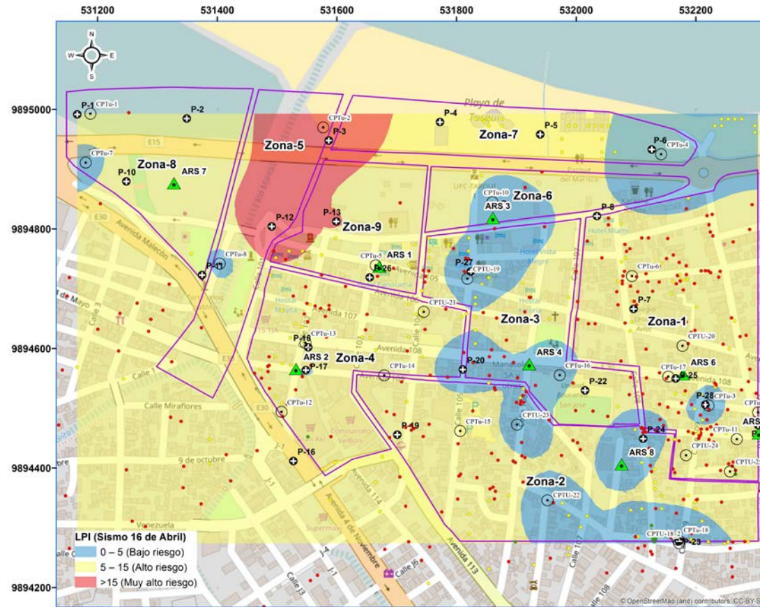
Figura 24. Mapa de valores promedio de LPI en base al SPT y CPTu (sismo 16 de abril, 2016). Fuente: (GEOESTUDIOS, 2016).
