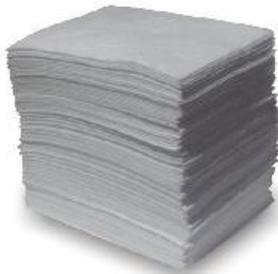
Los paños absorbentes son elaborados a partir de fibras sintéticas inertes, principalmente de polipropileno, bajo un proceso de extrusión y soplado a alta temperatura. Su método de fabricación se denomina Meltblown. El Meltblow produce finas fibras entrelazadas cuya característica es la absorción de un gran volumen de líquidos en relación a su peso.
