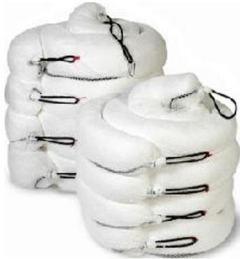
Son especialmente diseñados para que no absorban agua, es decir que tengan propiedades hidrofóbicas, así como oleofílicas ya que debido a su material capta rápida y eficazmente los hidrocarburos sin problemas de filtraciones ni goteos. Las barreras absorbentes sirven para contener un derrame y evitar que éste se siga expandiendo.
