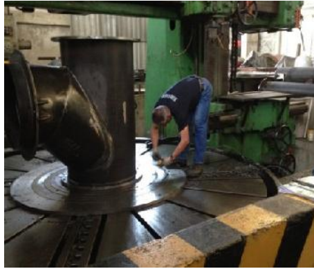
Imagen 4. Proceso de soldado de campana.
